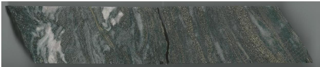
**Bild 1 und 2 - Kern aus Bohrloch GTCM21-001** . Dies ist der untere Teil der Campbell-Scherungszone. Das zweite Bild ist eine Nahaufnahme der Sulfidmineralisierung, der Alteration und der Quarzaderung des intensiveren Scherungsbereichs zwischen 412 und 415 m.
